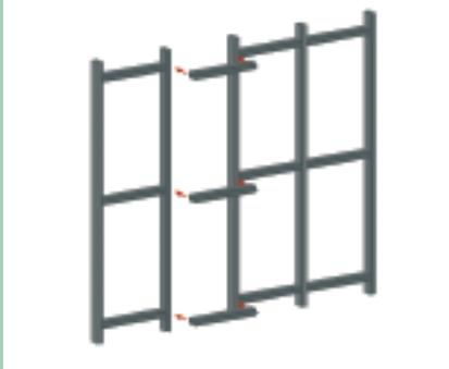
Beispiel einer Vorhangfassade in Pfosten-Riegel-Bauweise.
