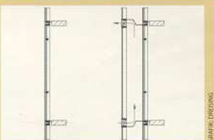
Bauarten von Elementfassaden: links: einschalig, rechts: zweischalig.
